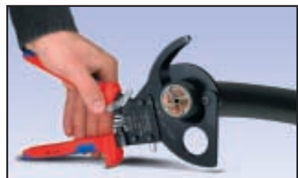
Der Kabelschneider wird auf einer festen Unterlage aufgestellt, so dass die gesamte Armmuskulatur eingesetzt werden kann.
